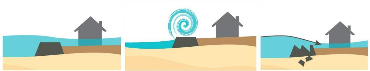
Figure 19 : Type de submersion - Débordement, Franchissement par paquet de mer et rupture
