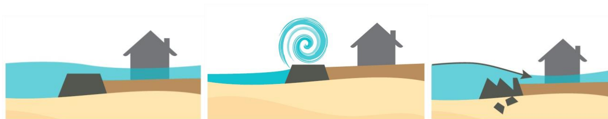
Figure 19 : Type de submersion - Débordement, Franchissement par paquet de mer et rupture (Données : CEPRI)
